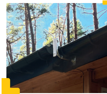
Hermetyczna obudowa punktu dostępowego EAP225-Outdoor w klasie szczelności IP65, pozwala na pracę urządzenia w trudnych warunkach pogodowych.
