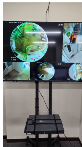
NVR からモニターに接続し、 院内各所の映像を確認
