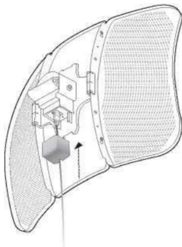
5. Připevněte montážní držák k zadnímu krytu tak, aby drážky na montážním držáku byly umístěny nad čepy na zadním krytu.
