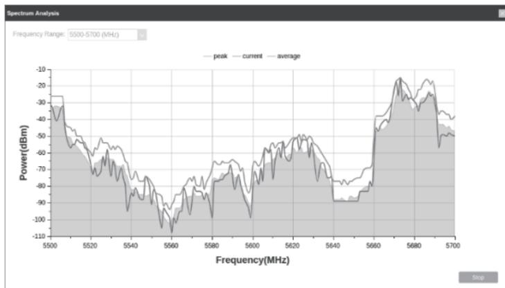
3. Při výběru kanálu / frekvence byste se měli vyhnout spektru s velkým rádiovým šumem. V tomto příkladu je doporučený kanál / doporučená frekvence 112 / 5 560 MHz.
