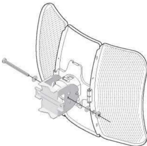
7. Připevněte sestavu CPE ke sloupu pomocí dvou svorek pro montáž na sloup a dvou šroubů M6 × 110 s maticí a pojistnou podložkou.
