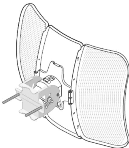
B. Zajistěte svorky pro montáž na sloup pomocí matic a podložek.
