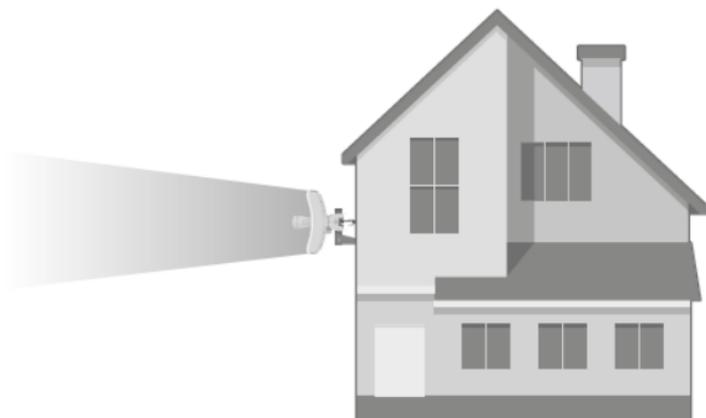
Zařízení CPE bez nainstalovaného reflektoru poskytuje venkovní pokrytí Wi-Fi v režimu Feed Only.
