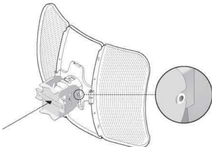
6. Připevněte montážní držák k zadnímu krytu pomocí šroubů M6 × 70 se sadami matic a pojistných podložek.
