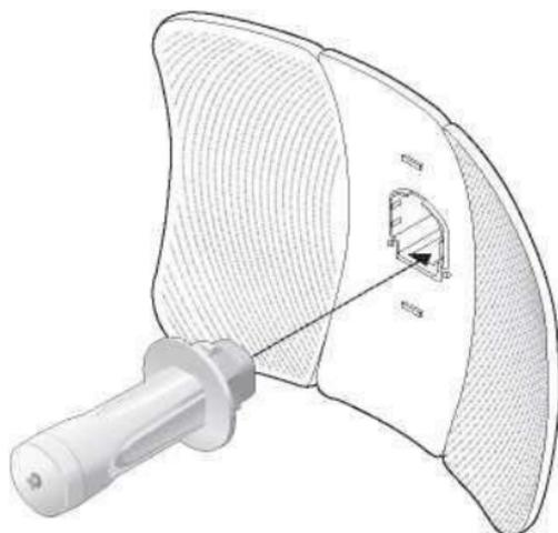
4. Připojte ethernetový kabel k zařízení Pharos CPE.
