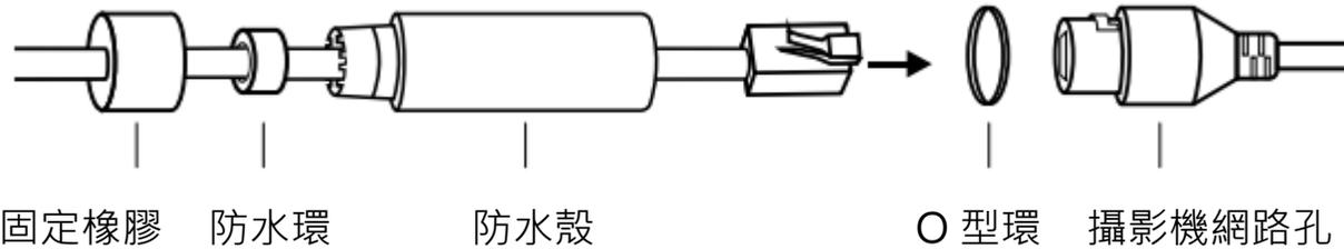
1. 在包裝內可找到上述零件，請依順序插進網路線中: 固定橡膠>防水環>防水殼。
